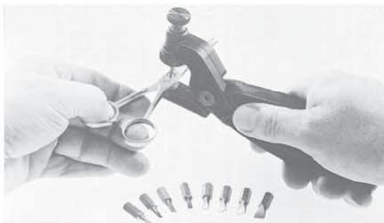
Tenaille pour ajuster la vis de serrage aux ciseaux
