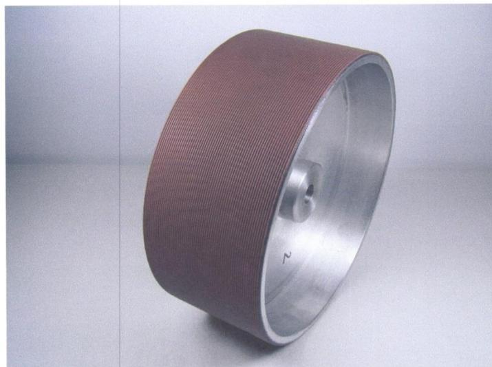
Comme un exemple: Voici une meule profilée ondulée Ø 300 mm x 120 mm de largeur, profil 2,0 mm ondulé (rond). Le corps de base avec embrèvement de chaque côté.
